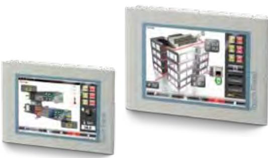
Графические панели оператора профессиональной серии предназначены для использования в различных системах управления технологическими процессами и системах автоматизации зданий. Благодаря прочному корпусу из литого алюминия со степенью защиты IP65 со стороны передней панели они с успехом могут применяться в тяжелых промышленных условиях эксплуатации.
