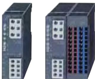
Блоки питания преобразуют входное напряжение сети переменного тока в напряжение 24 В постоянного тока, которое используется для питания модулей системы, а также датчиков и исполнительных устройств. Крепятся на 35 мм DIN-рейку, могут использоваться как в составе системы 200V, так и в качестве автономных устройств. Не имеют электрического соединения с внутренней системной шиной ПЛК.
