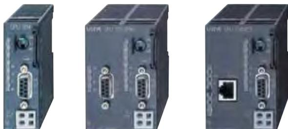
Процессорные модули (модули ЦПУ) осуществляют управление и регулирование технологическим процессом или оборудованием в соответствии с заложенной в них пользователем программой. Модуль ЦПУ выбирается исходя из решаемой задачи, и при этом он должен удовлетворять требованиям по производительности, объему памяти и набору коммуникационных интерфейсов.
