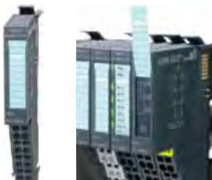
Функциональные модули являются интеллектуальными устройствами, которые самостоятельно выполняют такие технологические задачи как позиционирование, быстрый счет, перемещение и другие сложные функции. Они используются, когда требуется высокая точность и скорость выполнения таких операций.
