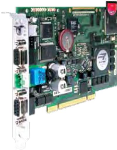
Контроллеры System 500S выполнены в формате стандартной платы расширения ПК с шиной PCI. Связь с объектом управления осуществляется с помощью станций ввода-вывода PROFIBUS DP, количество которых может достигать 124. Таким образом, оборудование всех других серий VIPA может быть использовано в качестве периферийных устройств для ПЛК 500S при построении децентрализованной системы управления.
