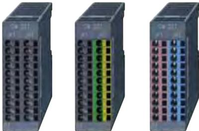
Клеммные модули представляют собой пассивные устройства, в которых вертикальные ряды контактов имеют внутреннее электрическое соединение. С их помощью реализуется размножение потенциалов цепей питания, что позволяет существенно облегчить подсоединение к ПЛК устройств с 2- и 3-проводной схемой подключения, таких, например, как датчики давления или приближения.
